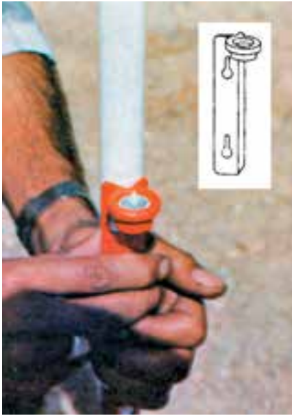
شکل ۱۰-۲- تراز نبشی و طرز استفاده از آن
