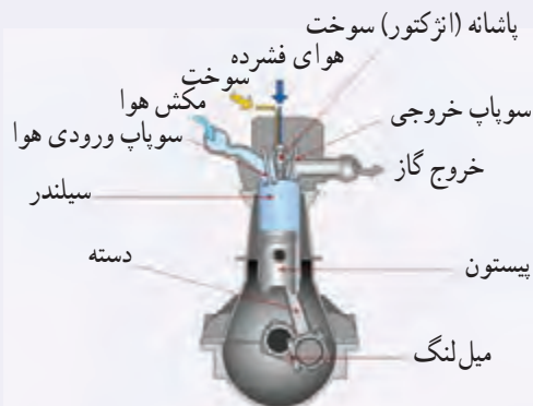
شکل ۵-۲۰ طرحی از اجزای یک ماشین دیزل
