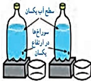
در این حالت شکل خروج آب از سوراخ‌های هر دو بطری شبیه هم است.
