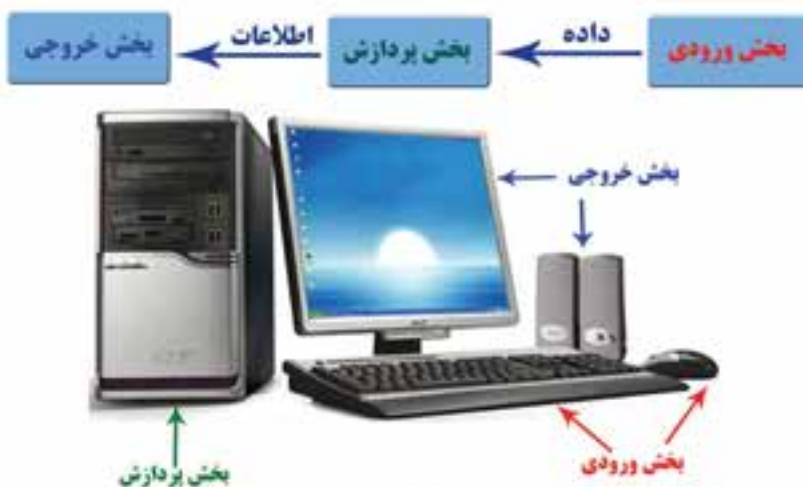
شکل (۱-۲) اجزای اصلی سیستم رایانه‌ای
