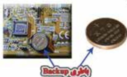
شکل (۱۸-۵) باتری Backup
