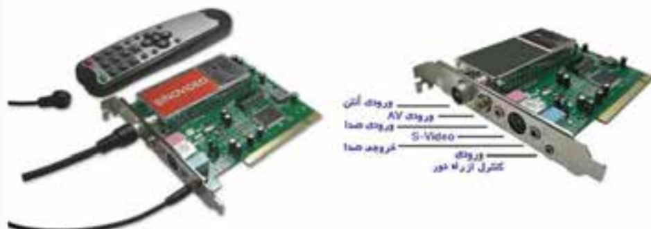
شکل (۳-۶) کارت تلویزیون ، کنترل از راه دور و درگاههای کارت تلویزیون
