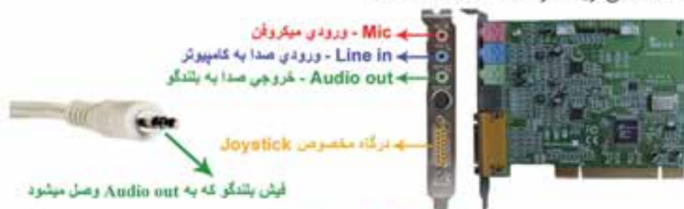
شکل (۴-۵) کارت صدا و اجزای آن
