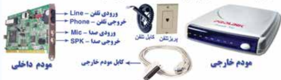
شکل (۴-۶) مودم خارجی و داخلی و اجزای آن
