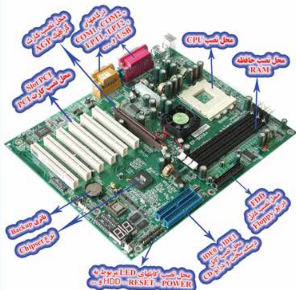
شکل (۵-۱) برد اصلی (Mainboard)
