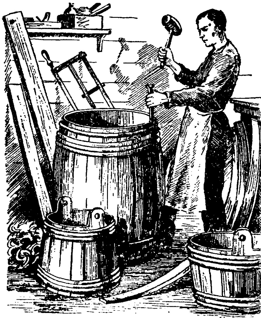
۱۵۷. تسمه‌هایی را که به شکل حلقه درآمده‌اند، به طرف قسمت پهن‌تر بشکه می‌برند، تا آنرا محکم دربر گیرند.
