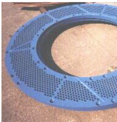
شکل 2-33- نمونه‌ای از سینی‌های مورد استفاده در Plate Tower
