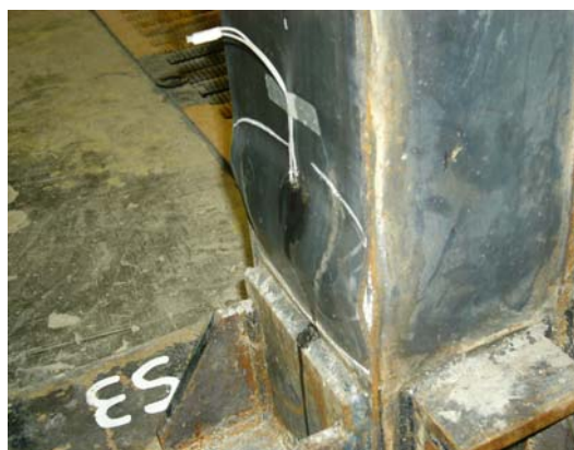
شکل ۲۳ شکست نمونه‌ی S3 در اثر کماتش موضعی جداره‌ی فولادی
