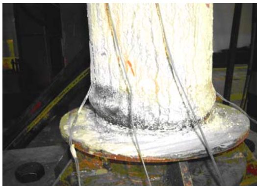
شکل ۲۵ شکست نمونه‌ی C3 در اثر کماتش موضعی حلقوی در پایین ستون
