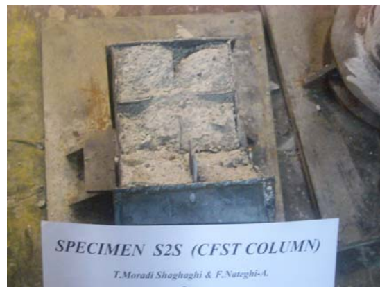
شکل ۲۹ شکست ورق‌های سخت کننده‌ی داخل نمونه‌ی S2S
