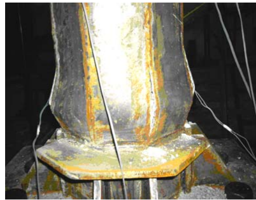
شکل ۲۶ شکست نمونه‌ی O3 در اثر کماتش موضعی جداره‌ی فولادی
