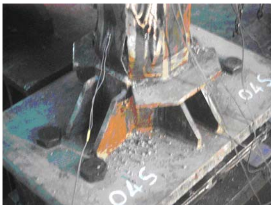
شکل ۳۱ شکست نمونه‌ی O4S در اثر کماتش موضعی جداره‌ی فولادی
