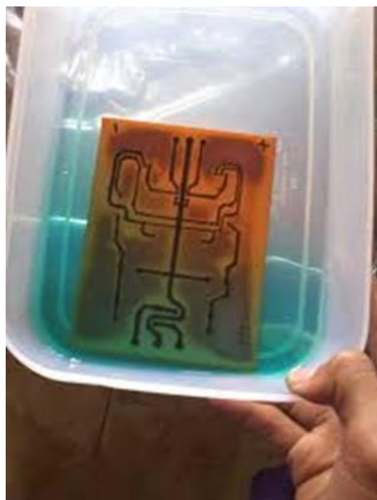
شکل ۱۶-۷- تکان دادن محلول برای خورده شدن مس اضافی فیبر
