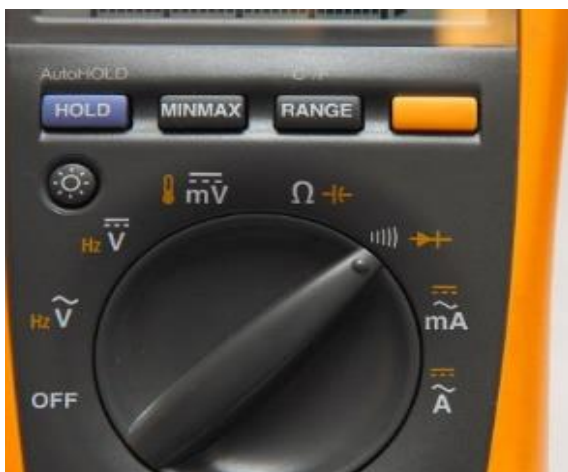
شکل ۳-۵ مولتی متر دیجیتالی در حالت آزمایش دیود
