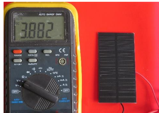
شکل ۹۵-۳ اندازه‌گیری ولتاژ سلول خورشیدی
