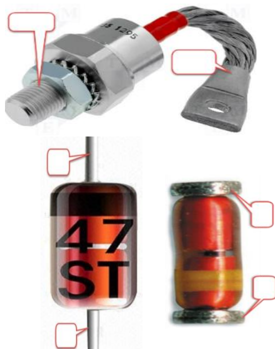
شکل ۳-۴ تعیین آند و کاتد دیودها
