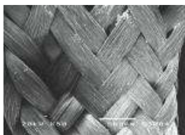
فایبرها بافته‌شده (Woven) که به صورت طنابی و در هم تنیده موجود می‌باشد
