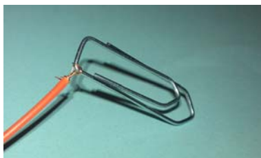
ب- بستن سیم به انتهای گیره ها
