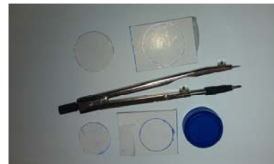
شکل الف- اندازه گذاری و بریدن صفحه های دایره ای
