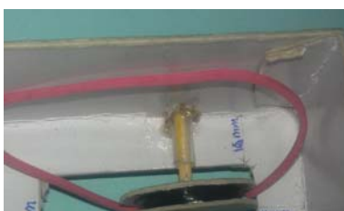
ث- بررسی دقیق تسمه و پولی
