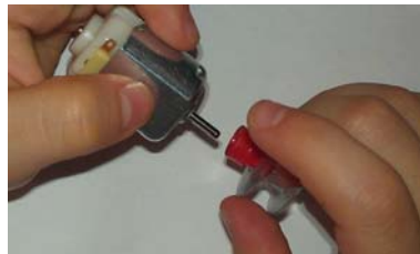
شکل ج- نصب مجموعه روی محور
