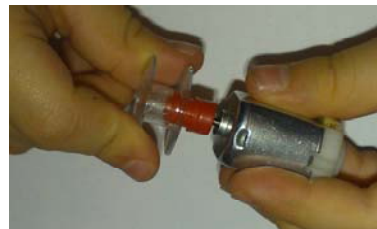
شکل چ- محکم کردن مجموعه روی محور
