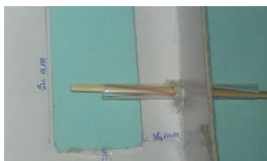
پ- عبور محور از بدنه و یاتاقان ها
