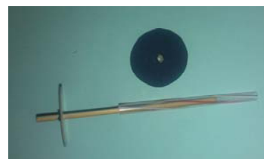
الف- محور و چرخ ها و یاتاقان
