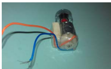
ب- محکم کردن سیم ها و عایق بندی آن ها
