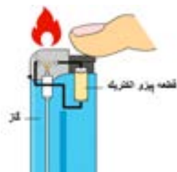
شکل ۱۱ (ج) - کاربرد پیزوالکتریک در فندک
