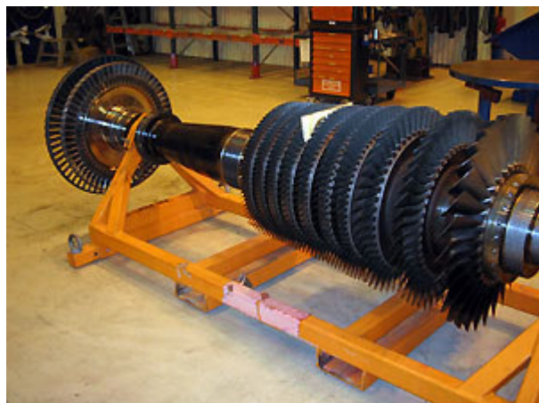
نمای ظاهری محور کمپرسور هوا و توربین قدرتی فشار بالای توربین گازی
