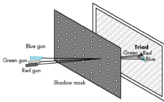
روش Shadow mask بیشتر روی سیستم های raster – scan استفاده میشود. این گونه مانیتور دارای سه صفحه فسفر اند. یکی نور قرمز، دیگری نور آبی و سومی نور سبز را از خود منتشر میکند. همچنین در این روش از سه تفنگ الکترونی استفاده میشود. سه پرتو الکترونی تولید شده بصورت گروهی متراکز و منحرف میشوند و پس از عبور از صفحه Shadow mask بصورت یک نقطه رنگی کوچک روی صفحه نمایش ظاهر میشوند.
