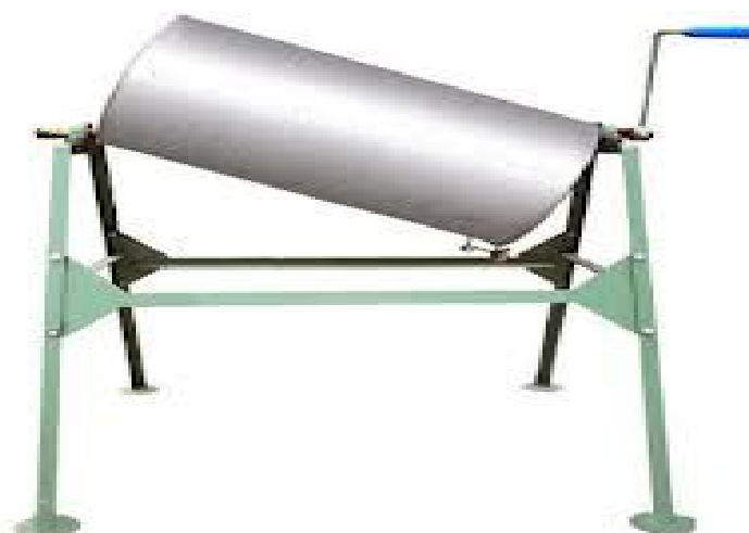
تصویر ۲: محفظه دوار برای بذر مال کردن بذور.
