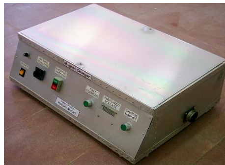
شکل ۳ - تصویر نمونه اولیه و نمونه نهایی یونیت اصلی مگنتایزر تخلیه خازنی
