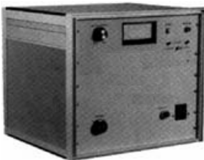
شکل ۳ - تصویر نمونه اولیه و نمونه نهایی یونیت اصلی مگنتایزر تخلیه خازنی
