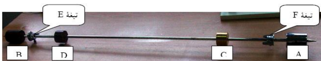
شکل ۲- شمای کلی آونگ کاتر مورد آزمایش
