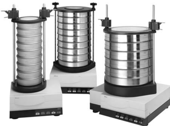
Fig. 3 Sieve shakers (photo: Retsch)
