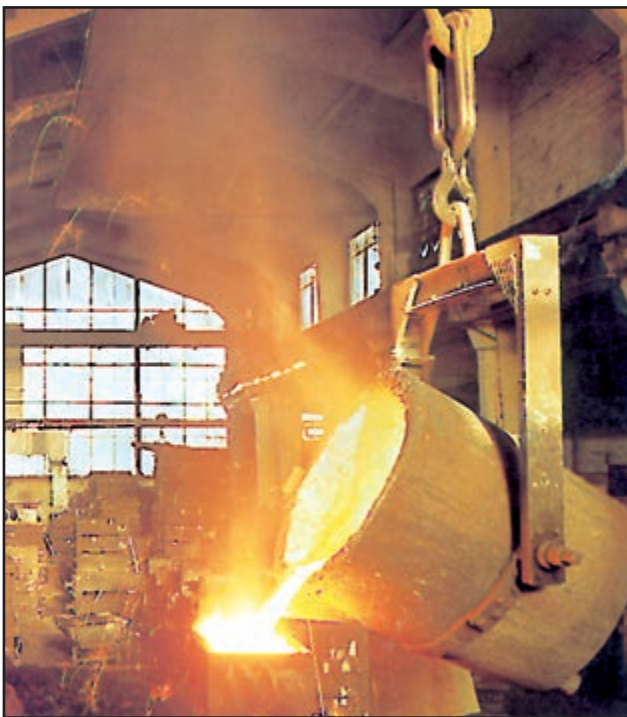
برای به دست آوردن فلزات، ابتدا سنگ معدن فلز را ذوب می‌کنند و سپس، فلز ذوب شده را در قالب می‌ریزند.
