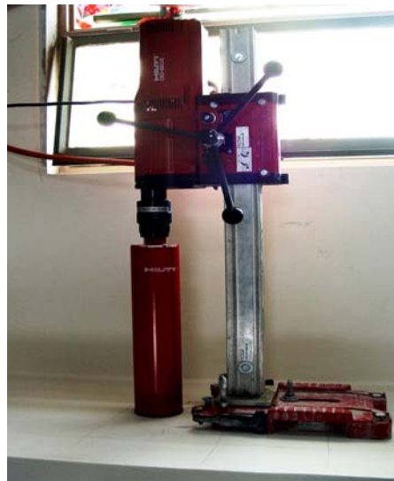
دستگاه مغزه گیری با متعلقات Core- DD-160E Hilti
