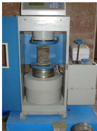
نمونه در دستگاه جک بتن شکن برقی
