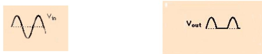
همانطور که در شکل زیر مشاهده می کنید. مسیر فیدبک توسط دیود ایجاد می شود. اگر شکل موج ورودی سینوسی باشد. این شکل موج را با عبارت  $V_{in}$  در کنار شکل می توانید در شکل بالا مشاهده کنید. خروجی این آپ امپ در حالتی که ولتاژ ورودی در سیکل منفی باشد، نزدیک به صفر است. که با صرفنظر کردن از این مقدار نزدیک به صفر آنرا صفر در نظر می گیرند. در این حالت ولتاژ های کمتر از ولتاژ هدایت دیود را از سیگنال ورودی در حالت عملی در خروجی نخواهیم داشت.
