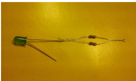
( شکل ۲۳) روش اتصال مقاومت ها به دیود
