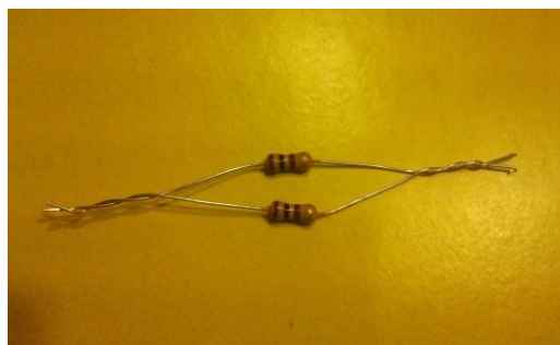
( شکل ۲۲) اتصال دو مقاومت به صورت موازی
