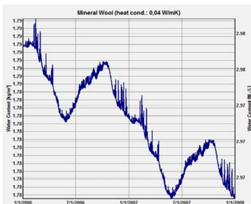
شکل ۶: تغییرات میزان رطوبت در لایه عایق حرارتی (پشم معدنی) با دو لایه بخاربند
