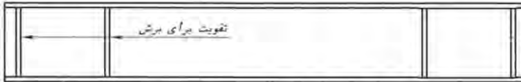
شکل ۲-۴-۳- اضافه نمودن ورق‌های سخت‌کننده عرضی
