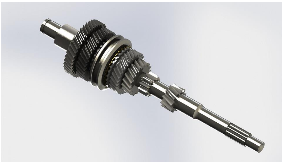
تصویر رندر شده مدل سه بعدی محور ورودی گیربکس پراید
