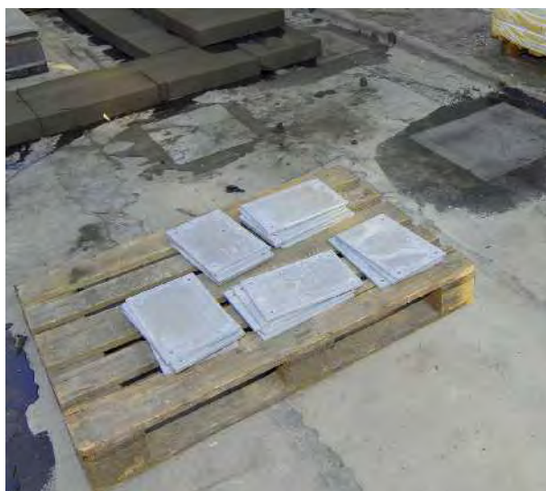
ورق‌های فولادی برای اتصال اعضای سقف.
