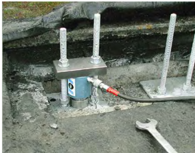
پیش‌تنیدگی نوارهای CFRP در سقف بتنی (تروفور، همکاران ۲۰۰۴)
