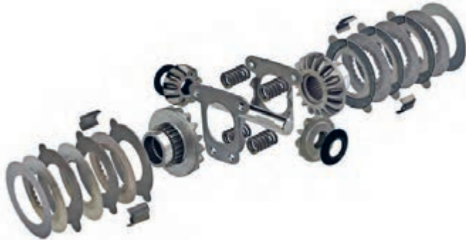
شکل ۴-۴ اجزای دیفرانسیل ضد لغزش
