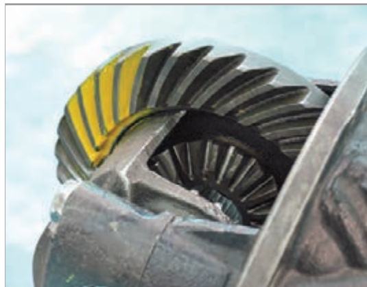
شکل ۴-۲۸- استفاده از رنگ برای کنترل
