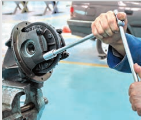
شکل ۵۳-۴- بستن کپه یاتاقان ها
