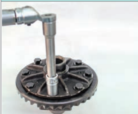
شکل ۵۰-۴- بستن پیچ‌های کرانویل
