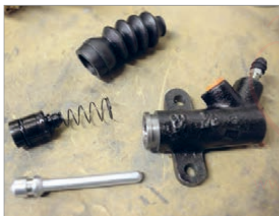
شکل ۱-۲۴- اجزای سیلندر اصلی کلاچ
