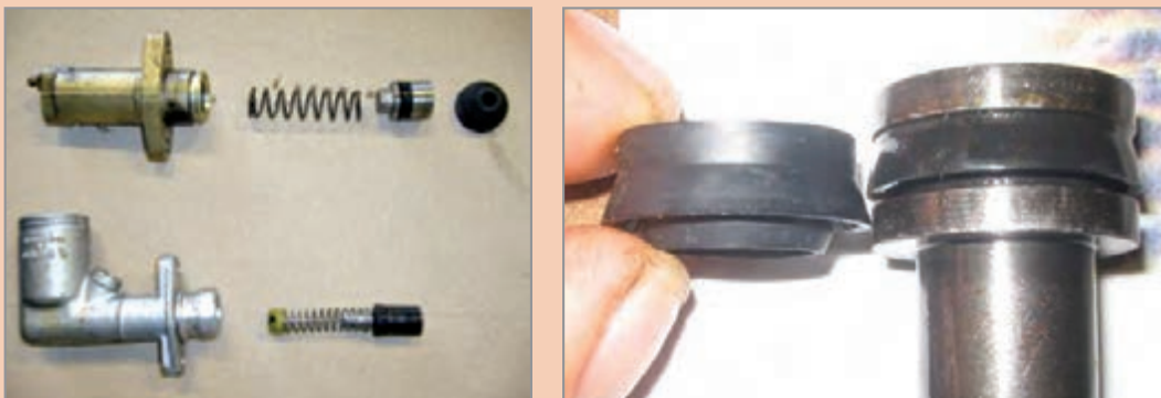
شکل ۲۱-۱- الف) نشتی داخلی در مدار هیدرولیکی
