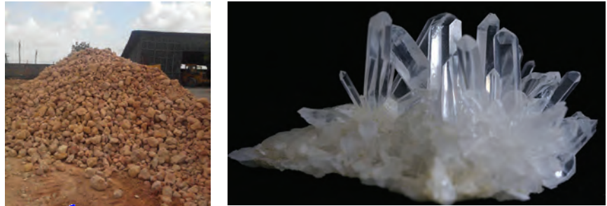
شکل ۷- (آ) سنگ معدن آلومینیم و (ب) سیلیس (آ) بوکسیت ( Al_2O_3 به همراه ناخالصی) سیلیس ( SiO_2 ) (ب)
