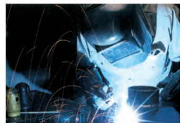
● استفاده از آرگون در جوشکاری
