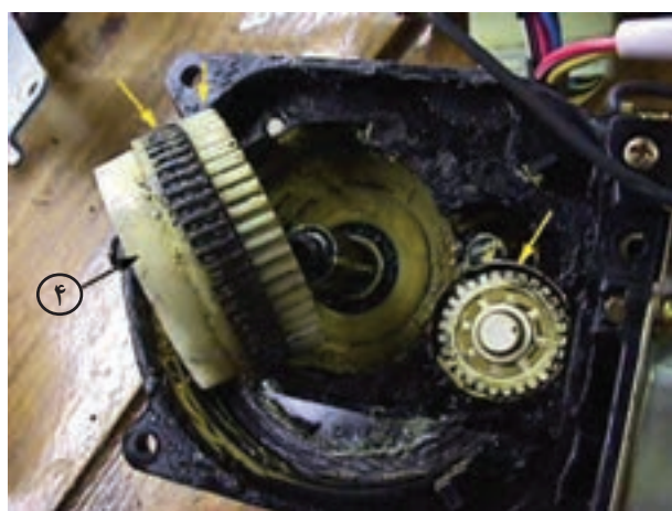
۱- چرخ دنده روی محور موتور الکتریکی ۲- چرخ دنده‌ی واسطه روی کلاچ ۳- چرخ دنده‌ی محرک تسمه‌ی دندانه‌دار میله‌ی آنتن ۴- کلاچ
