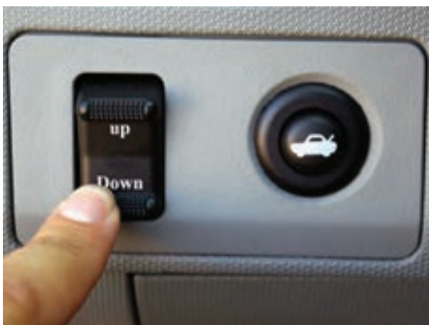
شکل ۱۲-۵- سوئیچ آنتن الکتریکی
