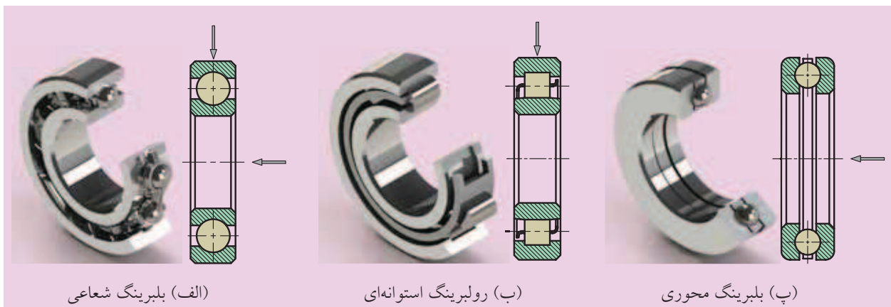
شکل ۶-۲۷ انواع یاتاقان‌های غلتشی
