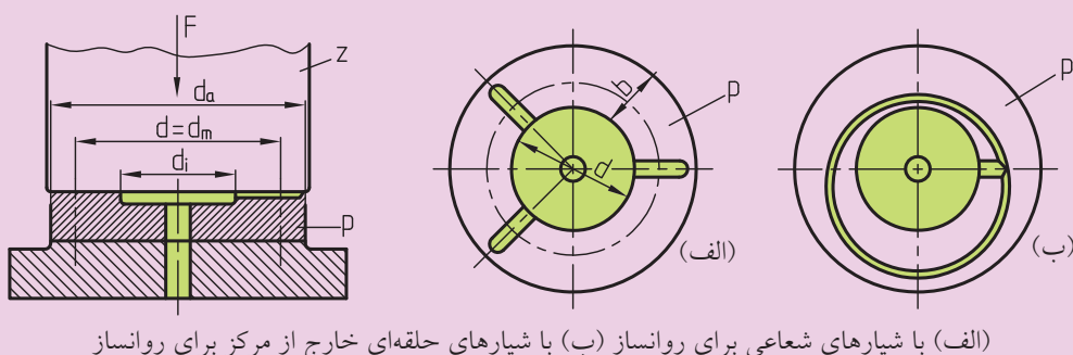
شکل ۶-۷ یاتاقان با صفحه افقی حلقه‌ای ساده
