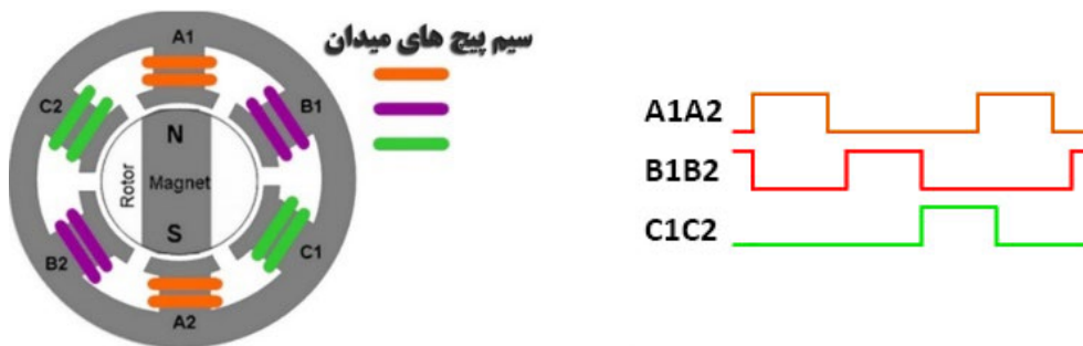
استاتور یک موتور بدون جاروبک و تغذیه سیم پیچ های آن
