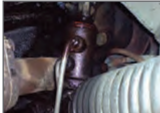
۲ نشتی شیر هیدرولیک فرمان (تقسیم‌کننده) بررسی شود.
