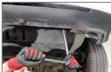
۳ چنانچه نیاز باشد، سینی زیر موتور باز شود.
