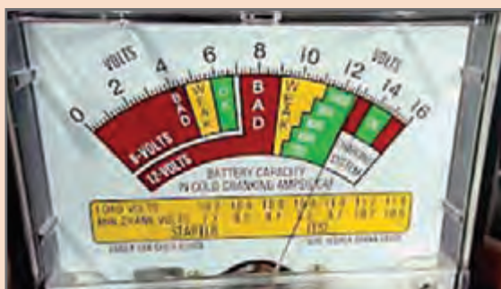
شکل ۳۰- نشان‌دهنده دستگاه آزمایش باتری
