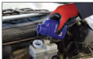
۲ مخزن مایع ترمز پر شود.
