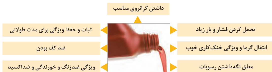
شکل ۲- ویژگی‌های اصلی روغن جعبه‌دنده
