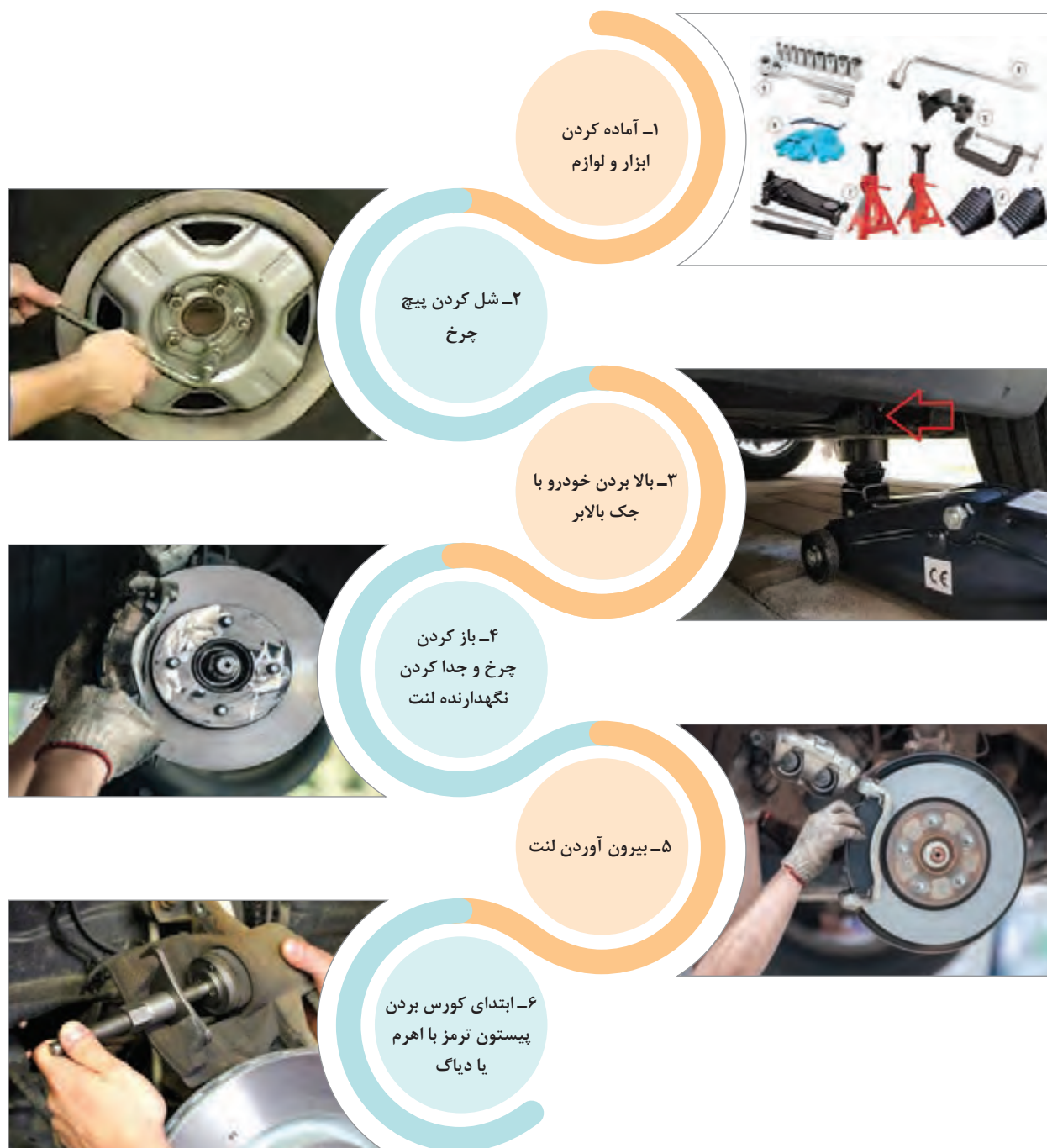
شکل ۶- مراحل باز کردن لنت دیسکی
