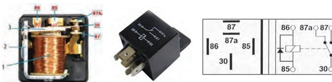
شکل ۱۹- نمادها و اجزای داخلی رله (۱- بوبین، ۲- بدنه، ۳- پلاتین)
