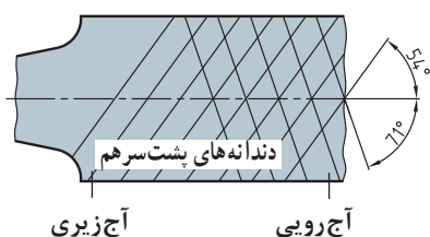
شکل ۱۶- وضعیت آج ها با زوایا و گام های مساوی
