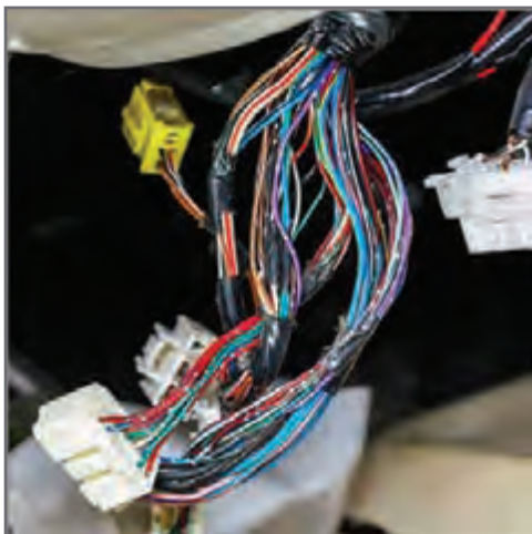
شکل ۷- کاربرد رنگ‌بندی برای شناسایی سیم
