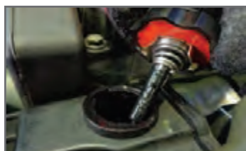
۹ سطح مایع درون مخزن بررسی شده و سپس مدار هواگیری شود.
