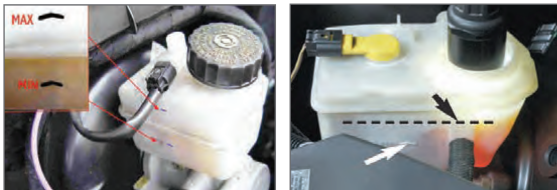
شکل ۵- بررسی سطح مایع هیدرولیک ترمز
