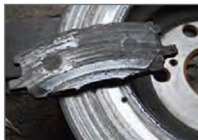
۴ پله یا خط افتادن روی دیسک
