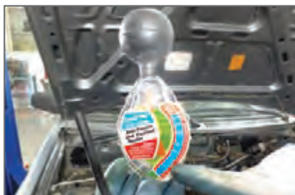
شکل ۸- روش استفاده از هیدرومتر
