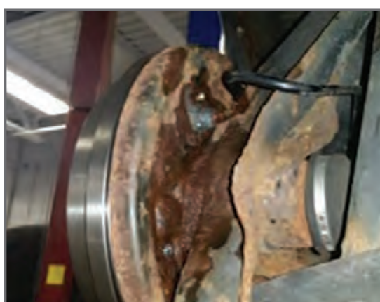
شکل ۱۱- بررسی لنت و کاسه چرخ
