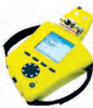
شکل ۴- دستگاه آنالیز روغن
