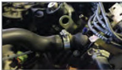
۴ اطراف محفظه ترموستات بررسی شود.
