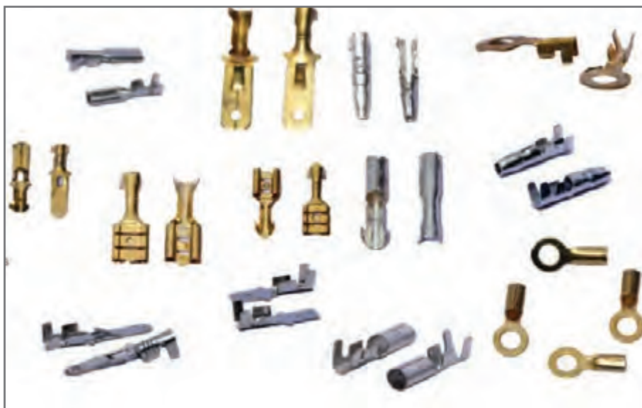
شکل ۸- نمونه‌های فیش به کار رفته در خودرو
