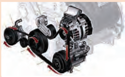
انتقال توان به تجهیزات جانبی با چند تسمه
