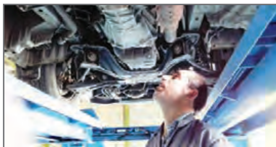
شکل ۶- قرار گرفتن خودرو روی جک بالا بر و دیدن محل های احتمالی نشتی
