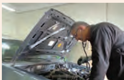
شکل ۱۹- کاربرد گوشی مکانیکی
