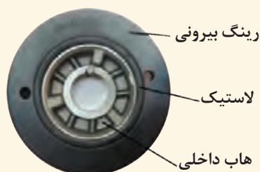
شکل ۹- پولی نوسانگیر (منجیددار)
