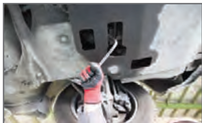
۱ پیچ تخلیه روغن جعبه دنده باز شود.
