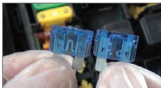
شکل ۱۶- مقایسه فیوز تیغه‌ای سالم و سوخته
