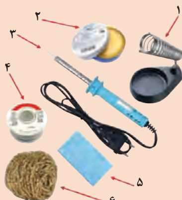
شکل ۲۴- ابزار اصلی لحیم کاری نرم
