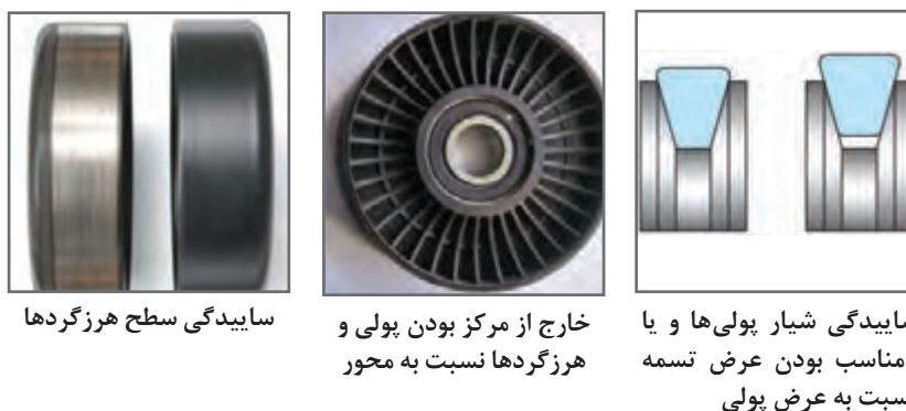
شکل ۱۳- عیوب‌های تسمه‌ها و متعلقات آنها
