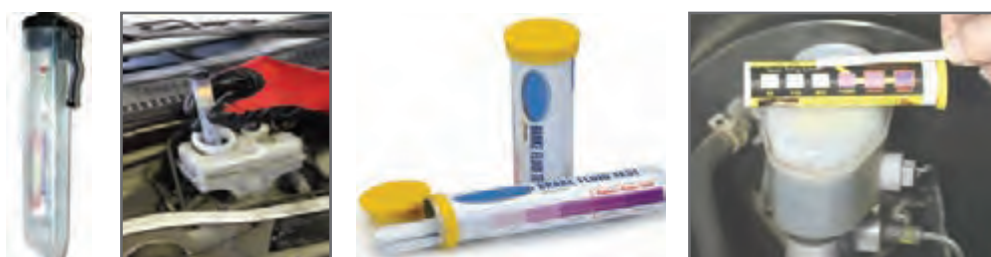
شکل ۶- آزمایش کیفیت مایع هیدرولیک ترمز
