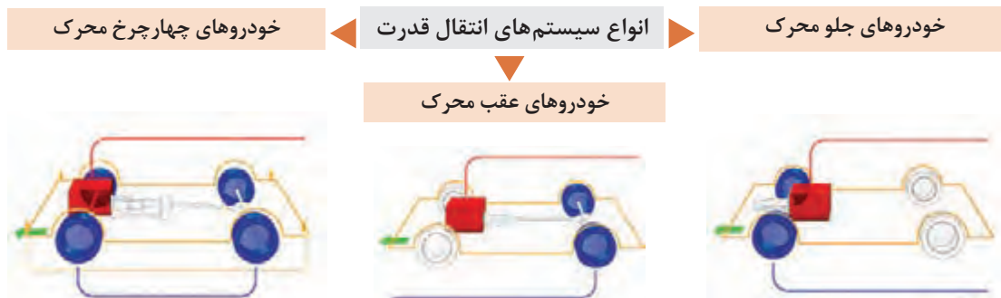
شکل ۴۷- اجزای اصلی سیستم انتقال قدرت
