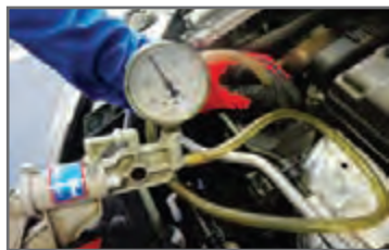
۲ با دستگاه پمپ دستی فشاری حدود ۱۶۵-۱۸۵kpa ایجاد شود.
