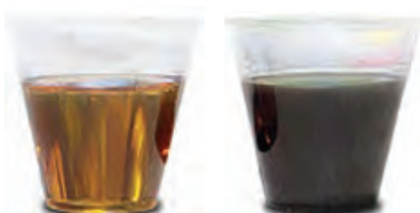
شکل ۴- تفاوت رنگ مایع هیدرولیک ترمز نو و کارکرده
