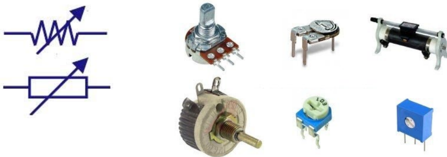
شکل (۴): انواع مقاومت های متغیر و نماد مداری آن
