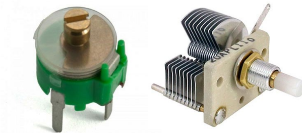
شکل (۱۰): مدل های مختلف خازن متغیر
