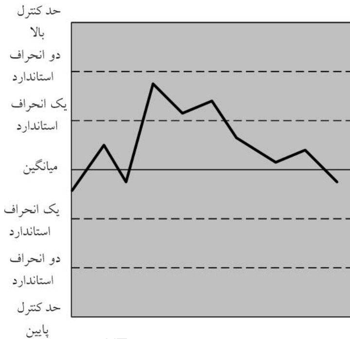
شکل ۲-۱۰ نمودار کنترلی برای فرآیندی در کنترل آماری
