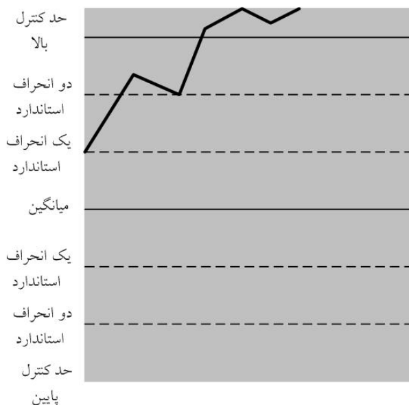
شکل ۳-۱۰ نمودار کنترلی برای فرآیندی که در کنترل آماری نیست
