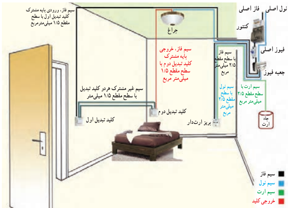
شکل ۱۸-۶ - سیم‌کشی مدار کلید تبدیل
