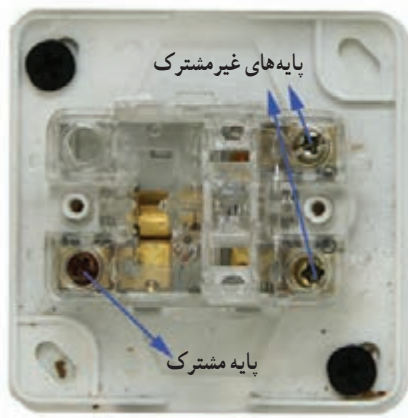
شکل ۱۹-۶- نمای داخلی یک نمونه کلید تبدیل
