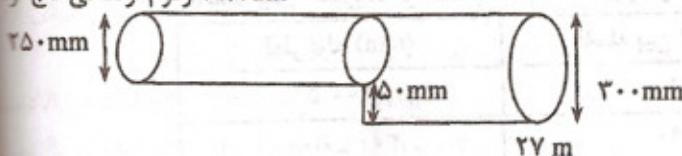
$$\begin{aligned} &(\text{قطر لوله در انتهای} + \text{قطر لوله در انتها}) - \text{رقوم تاج لوله} = \text{رقوم کف لوله در پایین دست} \\ &= 27/35 - (0/05 + 0/05) = 27/35 - 0/10 = 27/25 \end{aligned}$$
