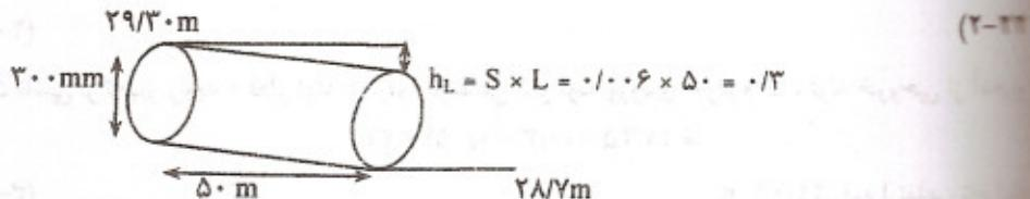
$$\text{ارتفاع لوله در} = \frac{29}{3} - (\frac{300}{1000} + \frac{28}{7}) = \frac{28}{7} \text{m}$$
