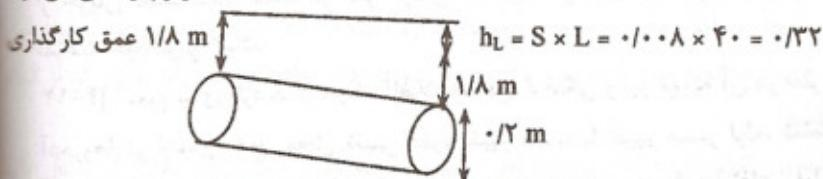
$$\begin{aligned} &(\text{عمق کارگذاری} + \text{قطر لوله} + h_L) - \text{رقوم سطح زمین} = \text{رقوم کف لوله در پایین دست} \\ &= 32/4 - (0/32 + 0/2 + 1/8) = 30/08 \end{aligned}$$
