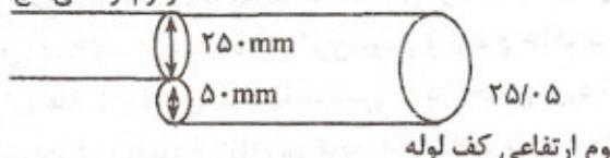
چون لوله خروجی با زاویه  $90^\circ$  درجه نسبت به قبلی می‌باشد رقوم کف لوله خروجی را  $5$  سانتی‌متر پایین‌تر در نظر می‌گیریم.
