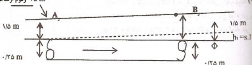
رقوم ارتفاعی کف لوله در انها ( نقطه B ) باید به اندازه افت فشار (  $h_L = S \cdot L$  ) پایین تر از رقوم ارتفاعی کف لوله در ابتدای خط ( نقطه A ) باشد تا جریان بطور ثقلی منتقل شود. بنابراین:
