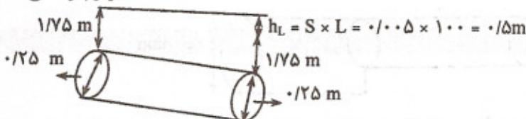
(قطر لوله + عمق کارگذاری لوله +  $h_1$ ) - ارتفاع ارتفاعی سطح زمین = ارتفاع کف لوله در پایین دست
