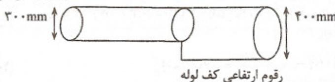
$$(\text{قطر لوله پایین دست}) - \text{رقوم ارتفاعی تاج لوله} = \text{رقوم ارتفاعی کف لوله} \\ = ۲۲/۷۵ - ۰/۴ = ۲۲/۳۵$$
