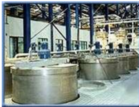
شکل 10-1- سری راکتور مخلوط شونده
