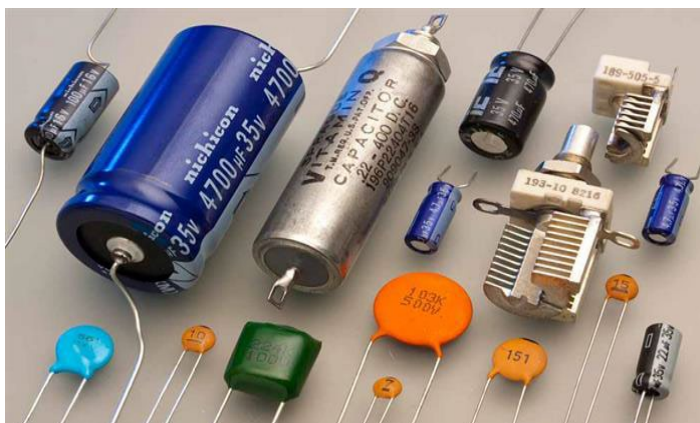
شکل (۶): خازن و نماد مداری آن
