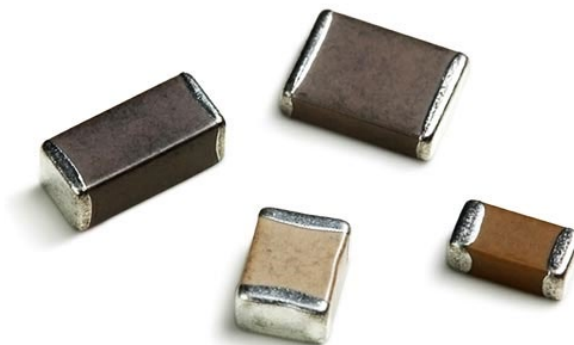
شکل (۹): خازن های نصب سطحی SMD
