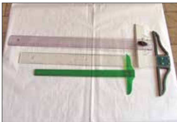
شکل ۱-۳۲ انواع خط کش تی با سر ثابت و متحرک
