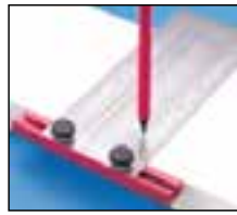
شکل ۱-۳۴ قرقره‌های متصل کننده‌ی خط کش به میز
