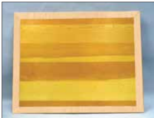
شکل ۱۵-۱ تخته رسم از جنس چوب با زهوار
