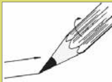
هنگام ترسیم خطوط باید مداد را حول محور خود به آرامی چرخاند.
