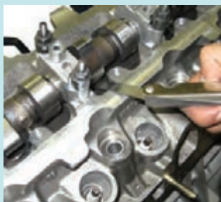
شکل ۵۷- روش فیلر زدن
