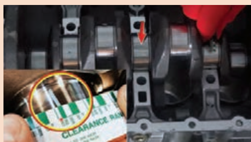
شکل ۹۷- برخی از نکات استفاده از پلاستی گیج برای تشخیص فاصله بین میل‌لنگ و یاتاقان ثابت
