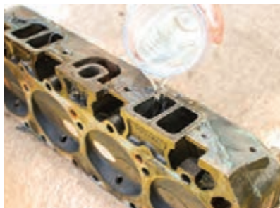
الف) نشستی سنجی سوپاپ‌ها با دستگاه خلأ سنج ب) نشستی سنجی سوپاپ‌ها با مایع در راهگاه سوپاپ‌ها
