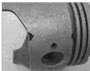
شکستگی دامنه پیستون
