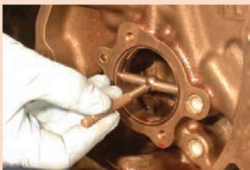
شکل ۳۸- بررسی لقی در یاتاقان یکپارچه
