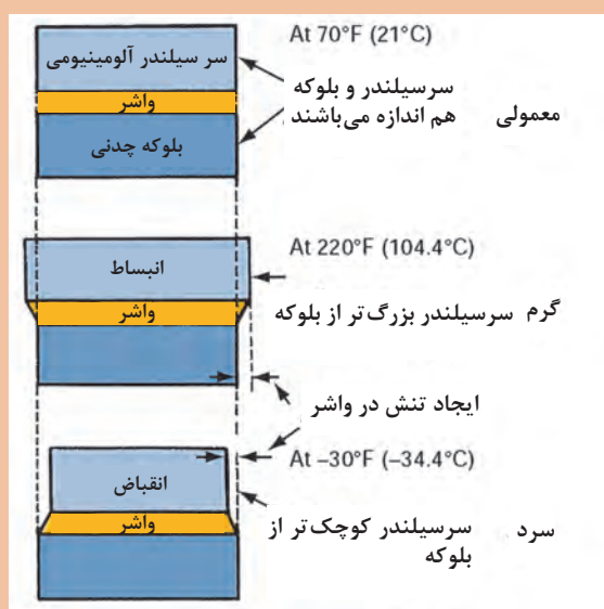
شکل ۹۹- اثر جنس واشر سرسیلندر
