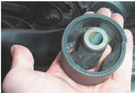
شکل ۵۹- پارگی دسته موتور
