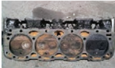
پ) ورود مایع خنک کننده به سرسیلندر
