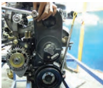
۲ تسمه تجهیزات جانبی باز شود.
