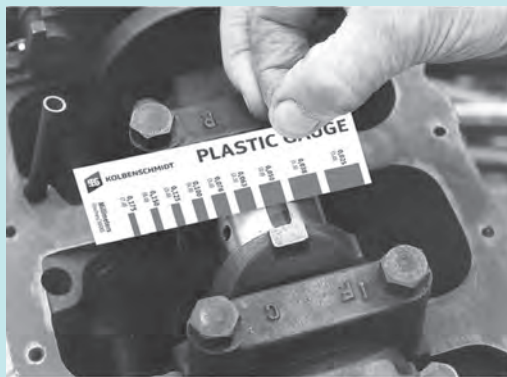
شکل ۹۸- بررسی قطر یاتاقان متحرک با پلاستی گیج
