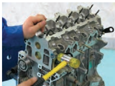
شل کردن سرسیلندر (در صورت نیاز با چکش لاستیکی)
