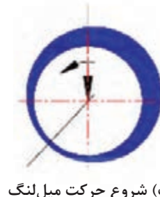
شکل ۴۲ - خلاصی بین یاتاقان و میل‌لنگ (فیلم روغن) در یک یاتاقان
