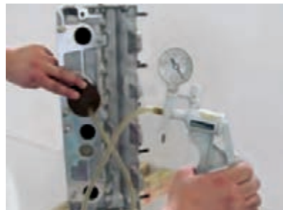
الف) نشستی سنجی سوپاپ‌ها با دستگاه خلأ سنج ب) نشستی سنجی سوپاپ‌ها با مایع در راهگاه سوپاپ‌ها
