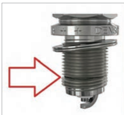
شکل ۷۲- بررسی رزوه های سرسیلندر
