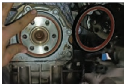
بررسی جای نصب کاسه نمد میل لنگ
