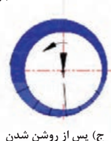
شکل ۴۲ - خلاصی بین یاتاقان و میل‌لنگ (فیلم روغن) در یک یاتاقان
