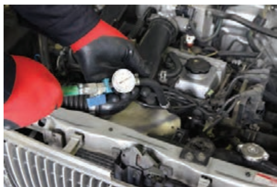
۴ هوای فشرده به سیلندر فرستاده شود و پس از بستن شیرمانومتر، به افت فشار عقربه دقت کرده و در صورت افت فشار مرحله ۵ انجام شود.
