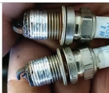
شکل ۷۲- بررسی رزوه های سرسیلندر
