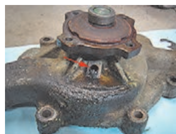
ت) شکستگی پایه‌ها
