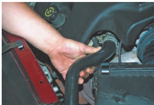
شکل ۲۴- برخی نکات مهم بررسی و عیب‌یابی و بستن مدار خنک‌کاری
