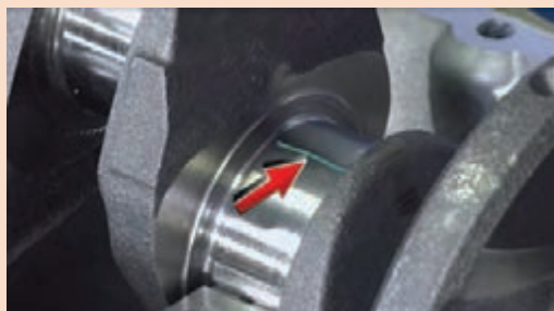
شکل ۹۷- برخی از نکات استفاده از پلاستی گیج برای تشخیص فاصله بین میل‌لنگ و یاتاقان ثابت
