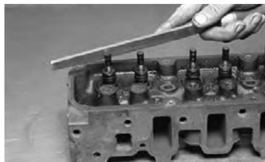
الف) پیش از بیرون آوردن سوپاپ‌ها، لبه یا پلیسه انتهای ساقی برطرف شود.
