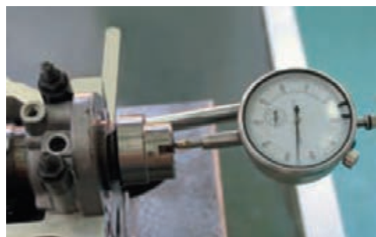
شکل ۸۹- بررسی لقی طولی میل سوپاپ
