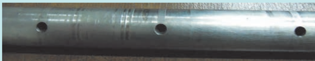
شکل ۹۲- کانال روغن در میل اسبک
