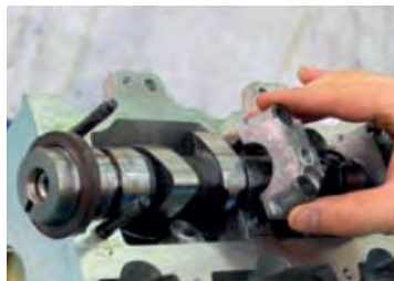
باز کردن پیچ های میل سوپاپ
