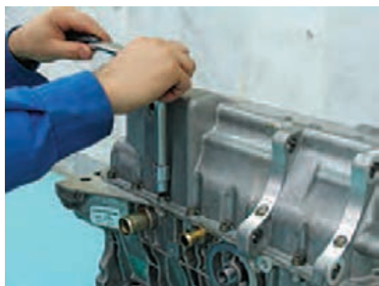
شکل ۸۰- باز کردن کارتر
