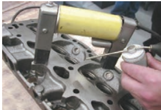
(الف) بررسی با دستگاه ترک یاب مغناطیسی
