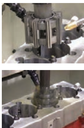
شکل ۸۲- ایجاد لبه در سیلندر و ابزار برطرف کردن آن (پله تراشی)
