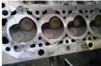
ب) خوردگی سرسیلندر در ناحیه مجاری مایع خنک کننده
