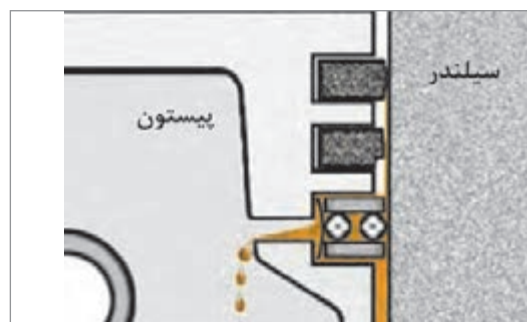
شکل ۱۶- وظایف رینگ‌های پیستون
