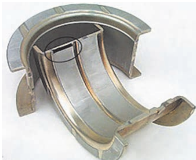
الف) بغل یاتاقانی یکپارچه با یاتاقان ثابت
