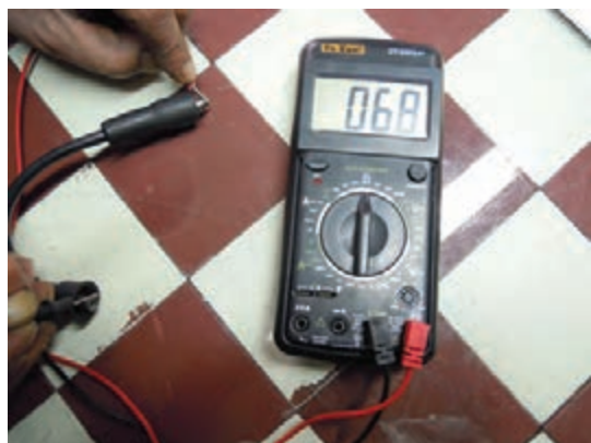
شکل ۲۹- آزمایش اهمی وایر شمع
