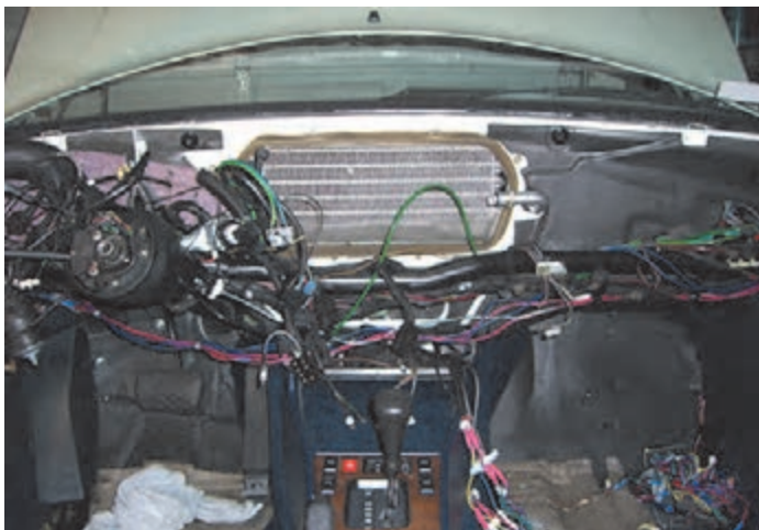
شکل ۲۳- باز کردن جلو داشبورد و لوله های رادیاتور بخاری
