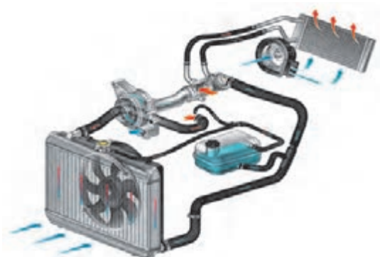
شکل ۱۴- لوله‌ها و شیلنگ‌های انتقال مایع خنک‌کننده
