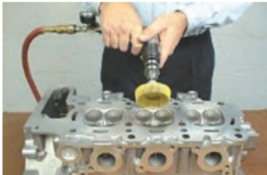
ب) کاربرد دریل پنوماتیکی با سنباده در رسوب‌زدایی اتاق احتراق و کف سرسیلندر
