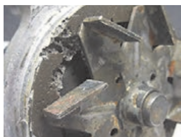
ج) خرابی بلبرینگ و خوردگی داخلی
