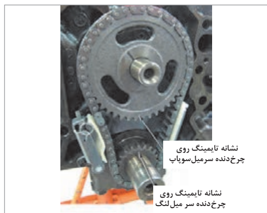
(الف) مکانیزم حرکتی زنجیری در موتور OHV
