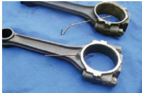
الف) سوراخ روغن پاش به کف پیستون و روغن کاری بوش گزن پین
