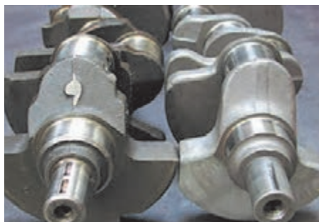
شکل ۳۰- مقایسه ظاهری بین میل لنگ‌های ساخته شده با روش ریخته‌گری و آهن‌گری
