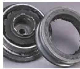
الف) پاره شدن لاستیک میان دو حلقه
