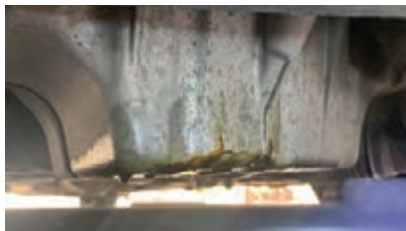
بررسی ترک و شکستگی کارتر
