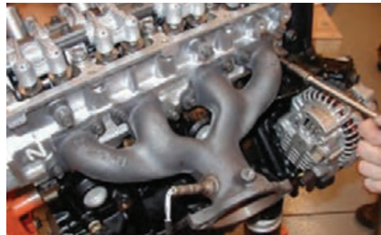
الف) باز کردن پیچ های مانیفولد خروجی
