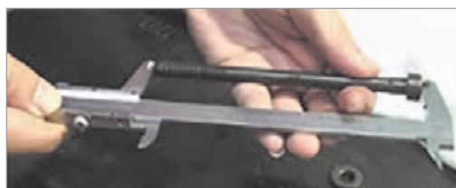
شکل ۹۷- اندازه‌گیری پیچ سرسیلندر
