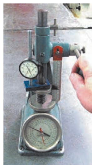
بررسی نیروی فنر سوپاپ
