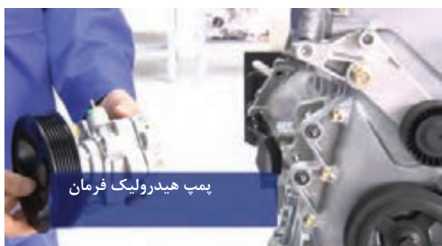
شکل ۷۶- باز کردن تجهیزات جانبی موتور
