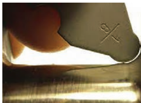
الف) اندازه‌گیری گردی لبه‌های لنگ
