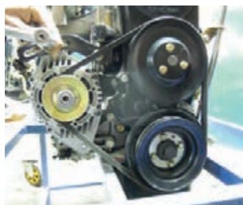
۳ در پوش جلوی موتور و پولی میل لنگ باز شود.
