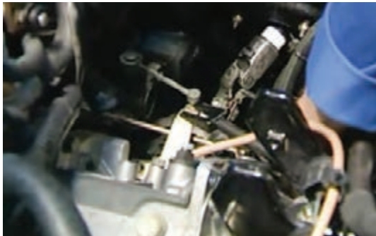
۲ اهرم‌بندی تعویض دنده باز شود.
