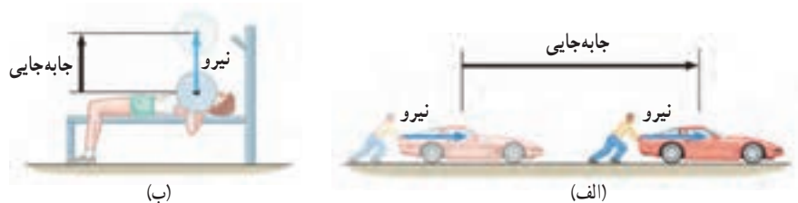
شکل ۲- انجام دادن کار در دو حالت مختلف؛ توجه کنید که نیرو و جابه‌جایی در یک جهت‌اند.
