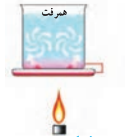
شکل ۸- آب گرم شده به سمت بالا حرکت می‌کند و آب سرد جای آن را می‌گیرد.
