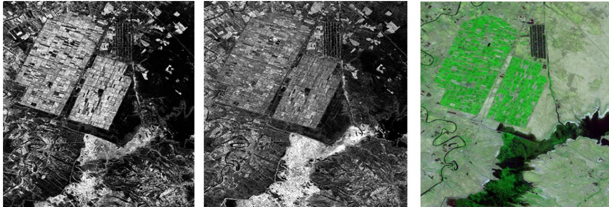
تصویر ۱۰ تصویر سمت چپ تصویر تصحیح شده با قطبش VH و تصویر میانی در قطبش VV و تصویر سمت راست تصویر کاذب لندست ۱۱ پهنه های سبز رنگ در این تصویر پوشش گیاهی هستند و پهنه های سیاه رنگ آب می باشند و ما بقی خاک لخت می باشد)
