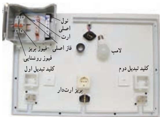
شکل ۵-۲۰- سیم‌کشی کلیدهای تبدیل
