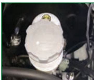
ج - در مخزن مایع ترمز را ببندید و اطراف آن را تمیز کنید.
