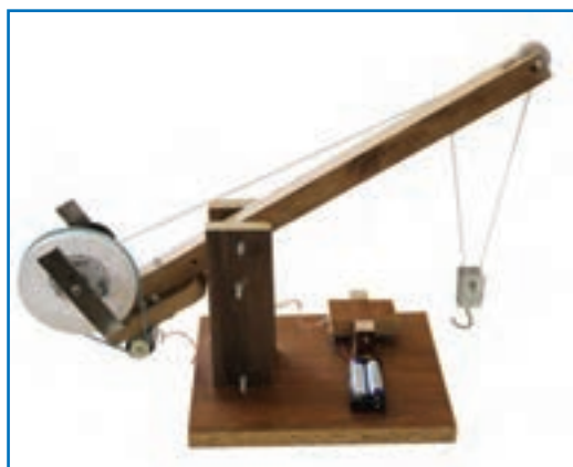
الف- ساز و کار حرکتی جرتقیل اسباب بازی
