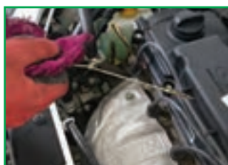
ب- میله اندازه‌گیر روغن موتور را بیرون بکشید.
