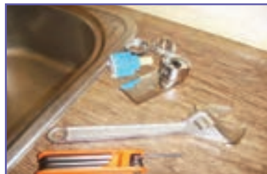
ح- اطمینان از سالم بودن قطعات و تعویض مغزی
