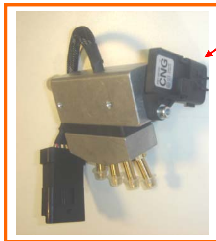
سنسور فشار- دمای گاز TMap Gas
