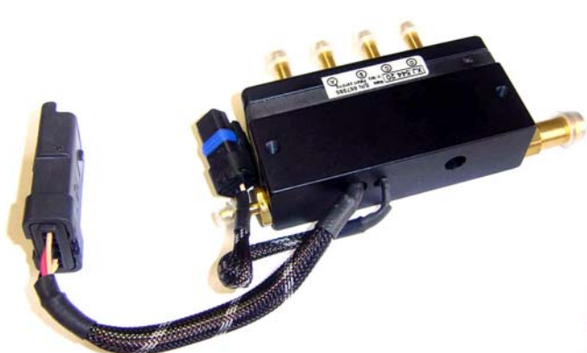
ریل سوخت و انژکتور Matrix
