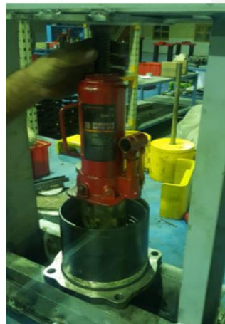
استفاده از چک برای اعمال نیرو و بیرون آوردن قسمت کس داخلی
