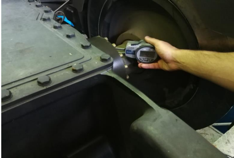
محل اندازه گیری T در بوژی.
