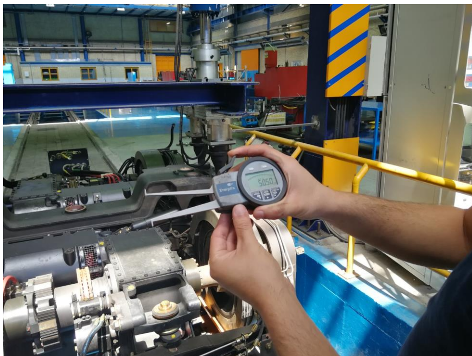
نمایی از پرگارهای دیجیتال داخل سنج مورد کاربرد در بار گذاری.
