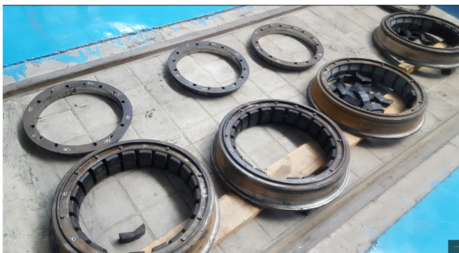
3.1.9. Wheel Hub و Detachable Ring را به وسیله ی تیتر و برس سیمی کاملاً تمیز نموده، سپس به وسیله اسپری لایه ای از زینک روی آنها می پوشانیم. اسپری زینک طلوسی رنگ بوده و مثل یک آستر روی قطعات را می پوشاند.
