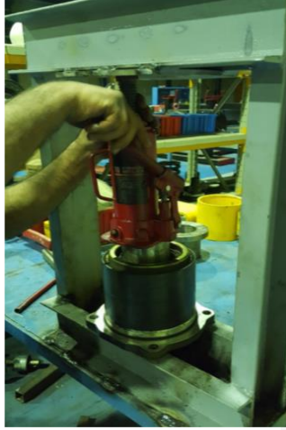
استقرار یک رابط لوله ای و سپس چک بر روی دیسک جهت اعمال نیرو
