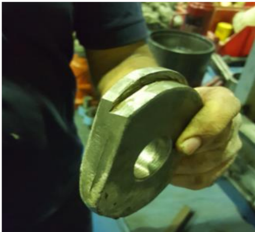
قرار دادن یک دیسک لبه دار که قطر بیرونی آن معادل قطر داخلی کس داخلی یاتاقان باشد.
