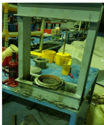
استقرار صفحه پشتی جعبه یاتاقان در زیر یاتاقان و در داخل
