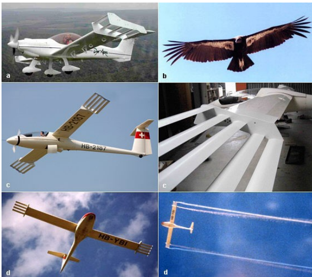
شکل ۹ چند نمونه هواپیماهای دارای wing-grid به همراه تصویر یک عقاب در حالت سر خوردن روی هوا
