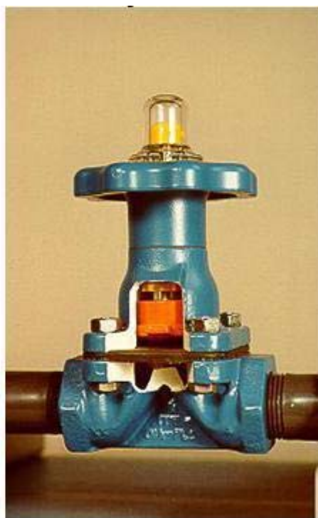
شکل ۹ - ساختار داخلی شیرهای دیافراگمی
