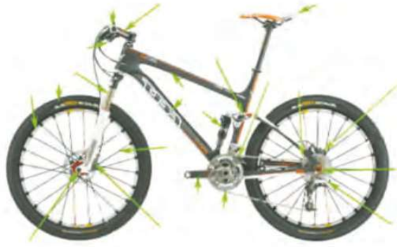
شکل ۳ - دوچرخه از اجزا یا ماشین‌های ساده‌تری مانند: اهرم، پیچ و مهره، چرخ و محور، چرخ و دنده و... تشکیل شده است.
