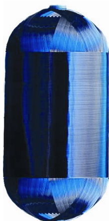
شکل ۱۰: طرح شماتیکی از الیاف پیچی کامپوزیتی به دور لایه آستری
