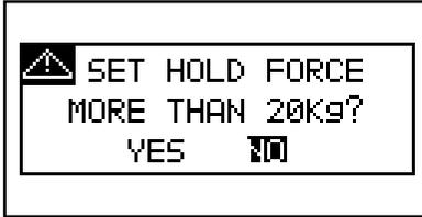
در هنگام تنظیم مقدار نیروی کشش اگر بخواهید مقدار نیرو را بیش از 20Kg انتخاب کنید پیام هشدار مبنی بر تنظیم نیرو با مقدار بیش از 20Kg نمایش داده می شود. اگر می خواهید اجازه استفاده از این مقدار نیرو داده شود گزینه YES را بوسیله کنترل کننده انتخاب کنید.
