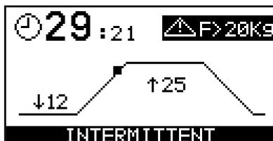
بعد از تنظیم مقدار پارامترها و فشار دادن کلید نمودار کشش INTERMITTENT و وضعیت کشش توسط نشانگر متحرکی روی شکل نمایش داده می شود.
