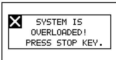
اگر اختلاف نیروی کشش واقعی و نیروی کشش تنظیم شده بیش از 3Kg باشد پیغام خطایی مبنی بر اضافه بار بیش از 3Kg داده می شود و دستگاه شروع به آزاد کردن طناب می کند و با زدن کلید STOP از این حالت خارج می شود.
