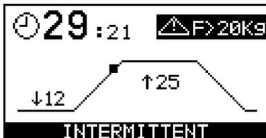
در هنگام Start شدن دستگاه با نیروی بیش از 20Kg در هنگام نمایش دادن وضعیت کشش در بالای صفحه پیام هشدار استفاده از نیروی بیش از 20Kg نوشته می شود که بعنوان نمونه در زیر صفحه مربوط به نمودار کشش INTERMITTENT نشان داده شده است.
