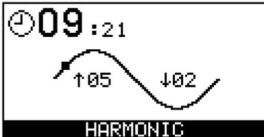
بعد از تنظیم مقادیر پارامترها و فشار دادن کلید Start نمودار کشش HARMONIC و وضعیت کشش توسط حرکت نشانگری روی شکل نمایش داده می شود.
