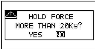
با فشار کلید Start برای شروع درمان اگر مقدار نیروی کشش بیش از 20Kg تنظیم شده باشد پیام هشدار مبنی بر استفاده از نیروی بیش از 20Kg نمایش داده می شود و در صورتی که مایلید درمان با مقدار تنظیمی انجام گیرد، گزینه YES را انتخاب کنید.
