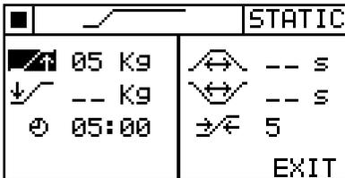
این کشش عبارت است از یک نیروی ثابت که در طول زمان درمان به بیمار اعمال می شود. در صفحه تنظیم کشش STATIC می توان نیروی کشش را از 2-99Kg و سرعت کشش را بین 1-9 تنظیم نمود.
