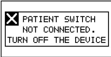
در صورت عدم اتصال Patient Switch (کلید اضطراری بیمار) به دستگاه خطایی مبنی بر متصل نبودن Patient Switch به دستگاه داده می شود در این حالت برای ادامه کار با دستگاه باید آن را یک مرتبه خاموش و روشن کنید.
