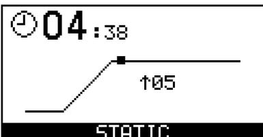
بعد از تنظیم مقادیر پارامترها و فشار دادن کلید نمودار کشش STATIC و وضعیت کشش توسط حرکت نشانگری روی شکل نمایش داده می شود.
